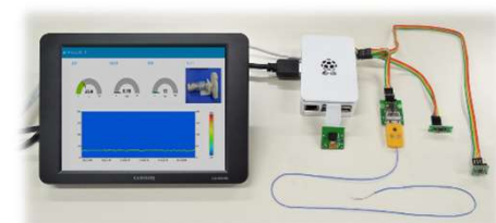
＜酒造用タンクの温度管理を数値化するデジタル機器の一例＞
