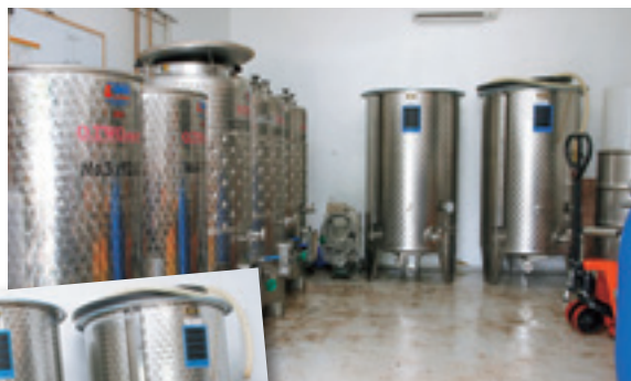
◀ 675ℓのワインを醸造できる、イタリア製タンク2基を設置。
