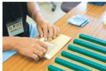
同じ位置に丁寧にテープ貼りができるよう、専用治具を作成。
