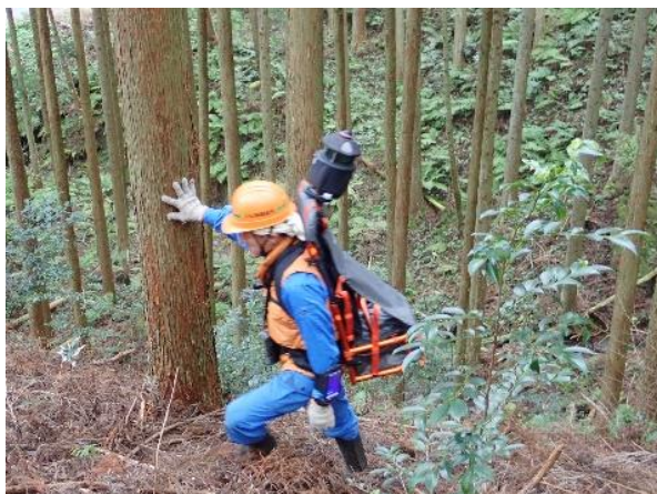
図3 3Dレーザー機器を活用し森林資源の情報をデジタル化
