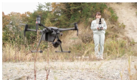
ドローンによる測量
