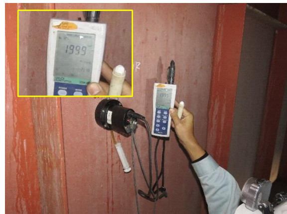
(b) 塩分量の計測 ( 1,999\text{mg}/\text{m}^2 以上付着)
