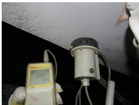
図解-10.7 ブラスト後の測定例 ( 322 \text{ mg/m}^2 が残存)
