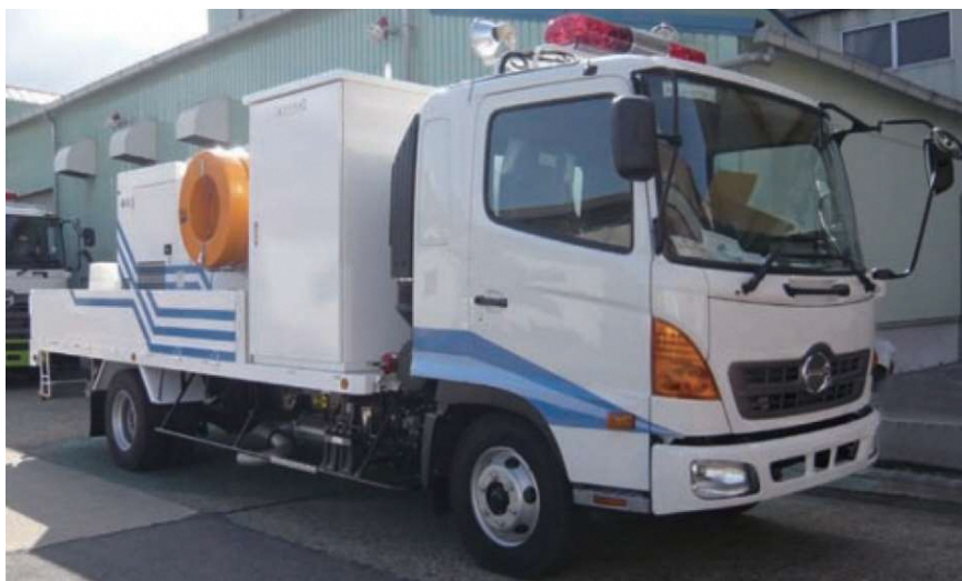
図 4-31 排水ポンプ車のイメージ
