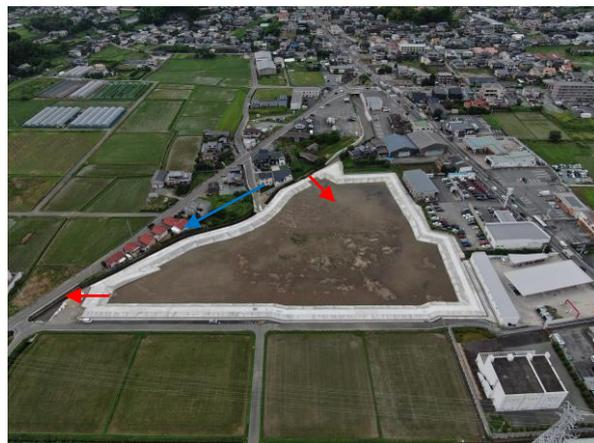
※ 平常時は調節池が空の状態。洪水時において、宅間田川の水を調節池に貯留し宅間田川の流量を低減する。
