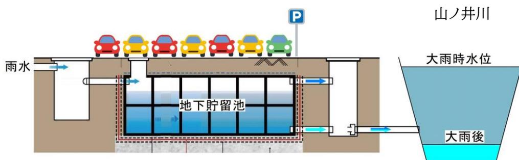
図 4-11 雨水貯留施設のイメージ
