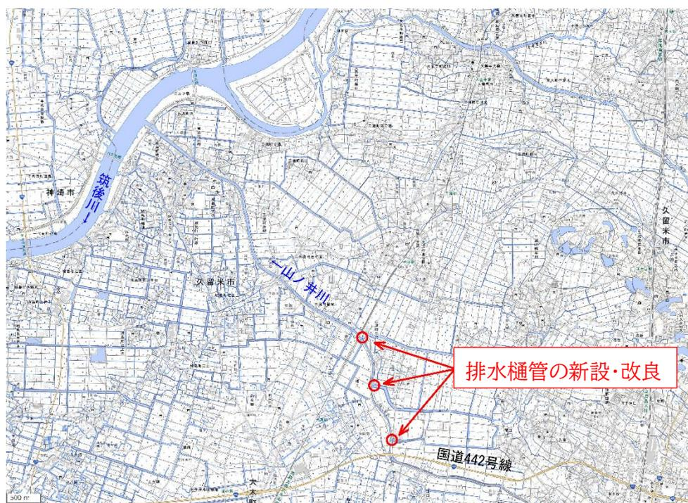
図 4-12 排水樋管の新設・改良位置図
