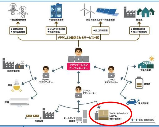
需要家側の負荷調整機能 (DR:デマンドレスポンス) を統合的に制御することで、 一つの仮想発電所(VPP)のように機能させ、再エネ電源の 変動成分に対する調整力とし て機能することが可能
