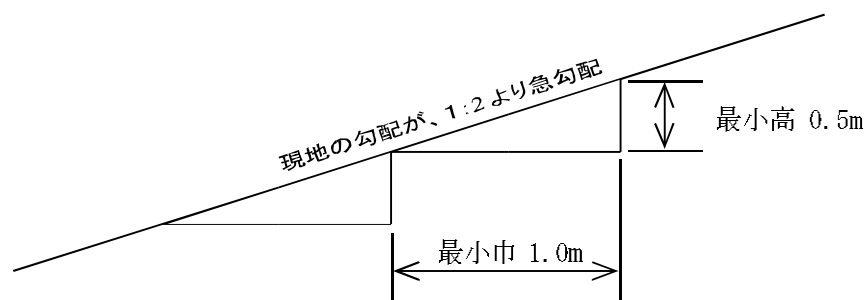
図 1-2-1 盛土基礎地盤の段切
