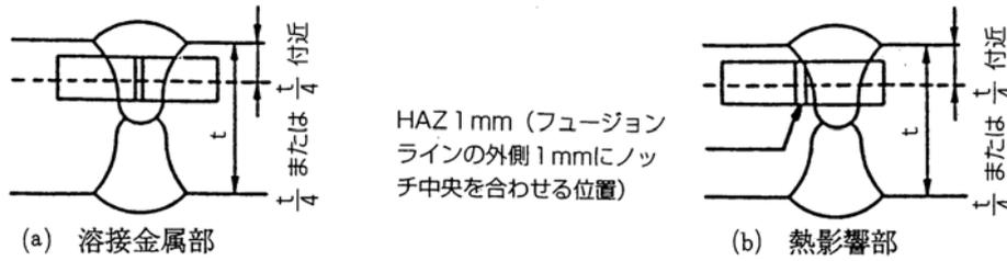
図 3 - 3 - 2 衝撃試験片採取位置
