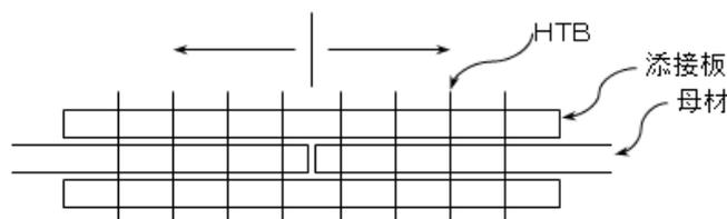
図 10 - 5 - 1 ボルト締付け順序
