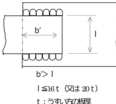
図 11-2-3 側面すみ肉溶接の重ね代(b')
