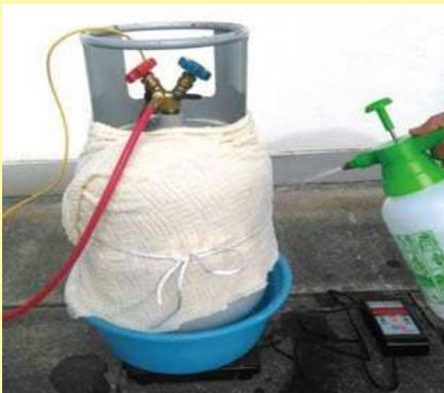
写真のように、ポンベを冷水に浸しつつ、濡れ雑巾を巻き付けて霧吹きを行い常に湿らせることで、効果的な気化熱による冷却が促進できます。
