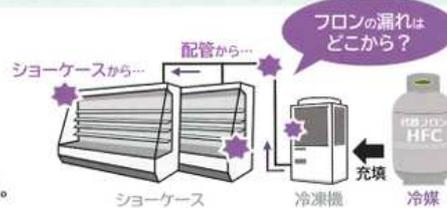
遠隔監視システムは冷えなくなる前に冷媒の漏洩を検知し
