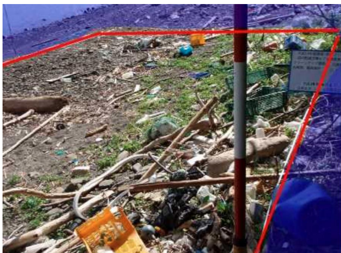
写真 3-2 漂着物量の目安 フレコンバッグで1 袋程度 (1,200 L) (ガイドラインより抜粋)
