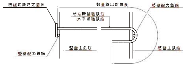
機械式鉄筋定着工法参考図
