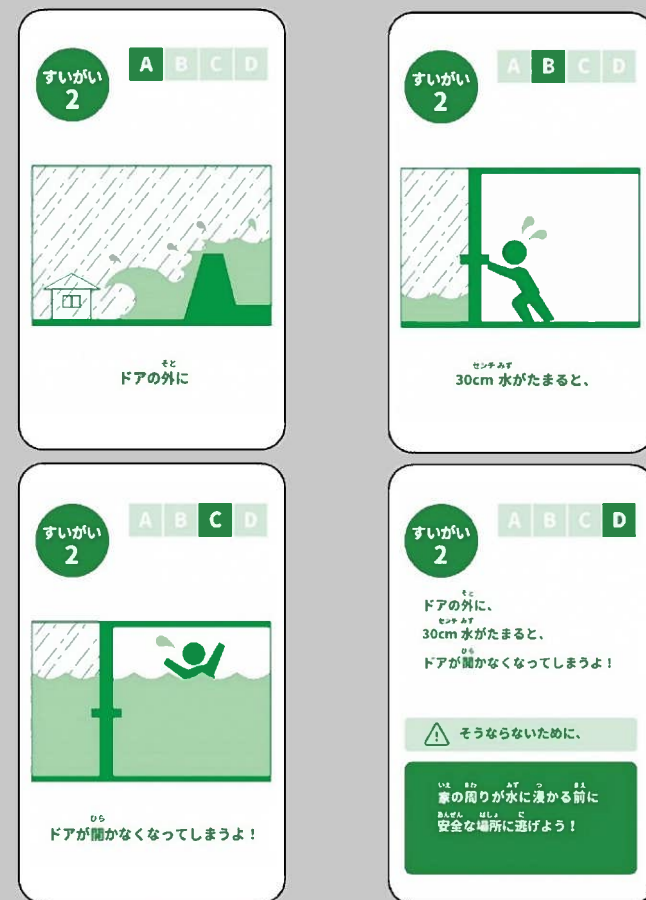
「すいがい2」のカードセット 水圧でドアが開かなくなる危険性を解説している例
