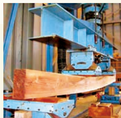
平角材の曲げ強度試験
