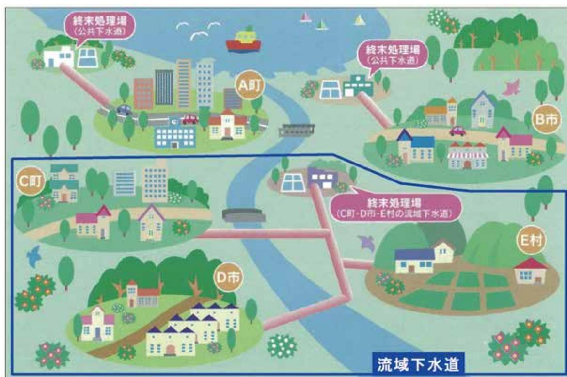
図Ⅲ-1 流域下水道の概要図
