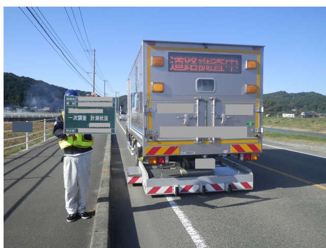
路面下空洞探査車
