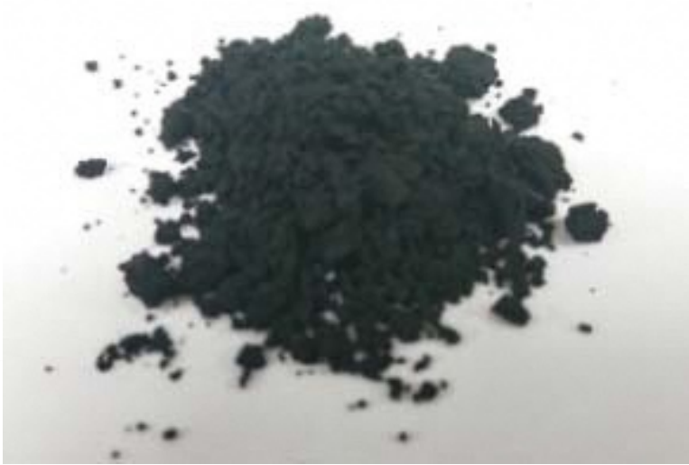
▲ Cotalyst BP的外观。是一种潮湿的黑色粉末，对水的分散性良好
