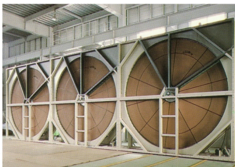
▲ VOC浓缩转轮。无机转轮表面涂有疏水性分子筛。
