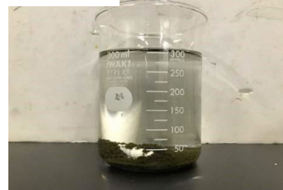
▲ ไม่เพียงแต่สลาย COD และ TOC เท่านั้นแต่ยังรวมถึงโลหะเชิงซ้อนด้วย หลังการบำบัดด้วยโอโซนของแคว้นน้ำใสบนบนจะไม่มีสีและโปร่งใส
