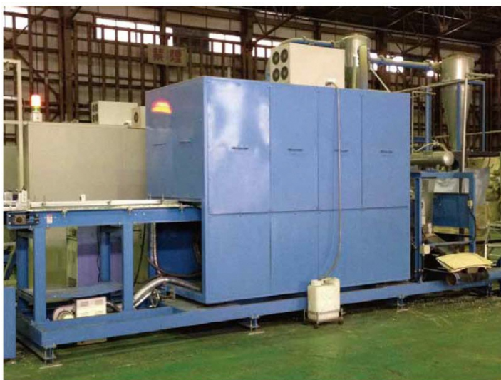
▼ ภาพมุมมองภายนอกของอุปกรณ์คัดแยกพลาสติกรามัน
