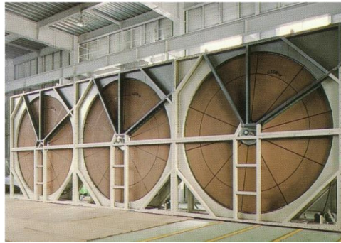
▲ โรเตอร์ VOC เข้มข้น ซีโอไลต์ไม่ชอบน้ำได้รับการปรับปรุงบนอันนี้แคมป์บ่อนัทรีซี
