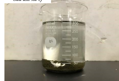
▲ Phân hủy không chỉ COD và TOC, mà còn cả các phức chất kim loại. Phần chất lỏng không kết tủa còn lại ở trên sau khi xử lý ion trở nên không màu và trong suốt.
