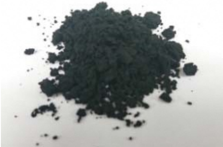
▲ Hình dạng của Cotalyst BP. Bột màu đen, có hơi ẩm, phân hủy tốt trong nước.
