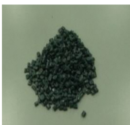
架橋型発泡 PE をペレット化
