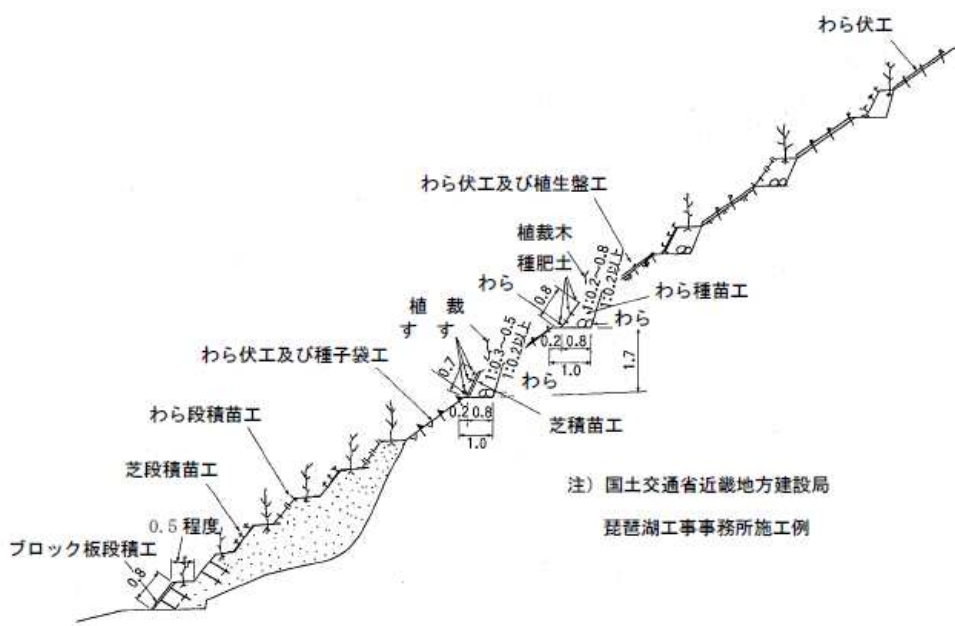
図3-2-39 とくしゃ地（施工例）断面図（単位：m）
