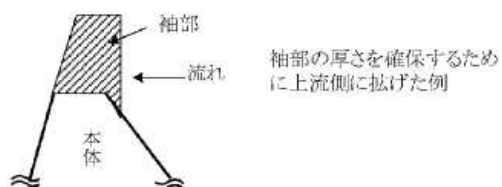
図 4-1-43 袖部天端幅の拡幅例
