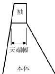
図 4-1-18 砂防堰堤側面図と部位名称
