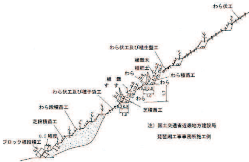
図3-2-39 とくしゃ地 (施工例) 断面図 (単位: m)
