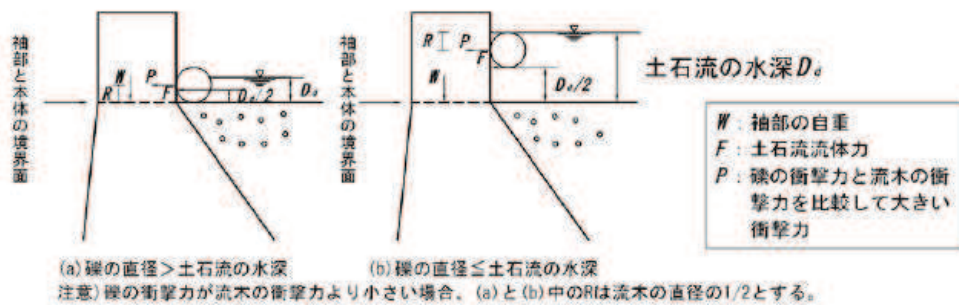
図4-1-44 袖部と本体の境界面および設計外力とその作用点
