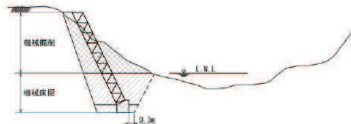
図 4-2-61 護岸工の土工標準図
