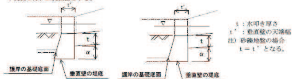
図 4-2-40 垂直壁の根入れ及び断面
