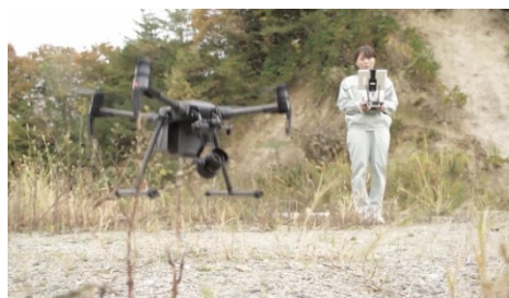
ドローンによる測量
