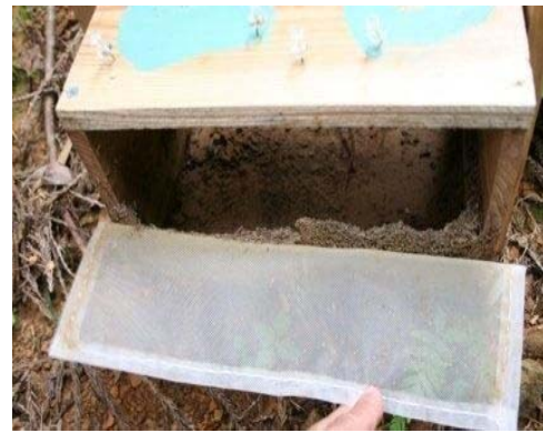
写真-7 土砂受け箱に貯まった土砂
