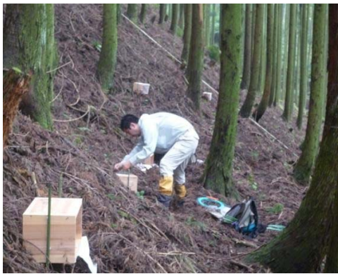
写真-6 土砂受け箱の調査
