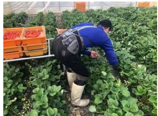
アシストスーツによる作業性改善実証試験
