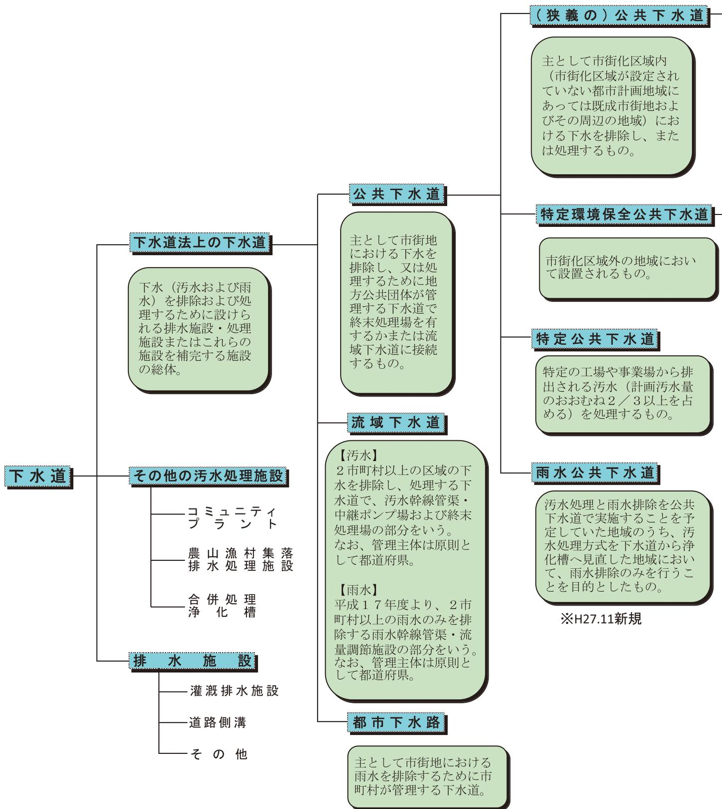
図 I - 4 下水道の種類
