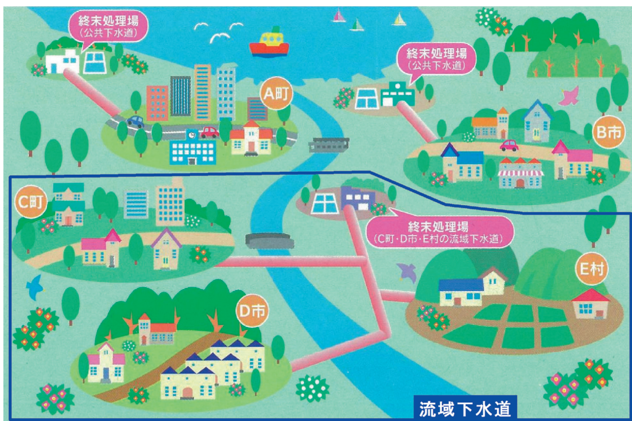
図Ⅲ－1 流域下水道の概要図
