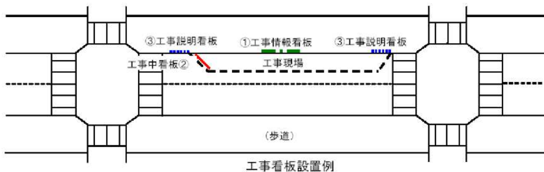
標示板の設置場所
