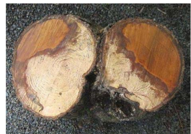
腐朽部の断面
