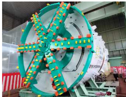
シールドマシン仮組立(工場)完了 【堺(大阪)工場にて】
