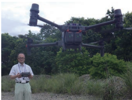
最新型小型赤外線カメラ搭載ドローン
