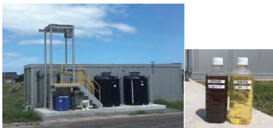
築上町が建設した全国初の新技術を用いた液肥濃縮施設と、濃縮前(左)濃縮後(右)の液肥
