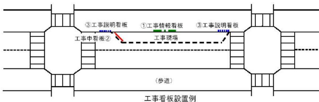
標示板の設置場所
